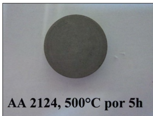
Figura 4. Discos dos compósitos óbitos por sinterização a vácuo.
