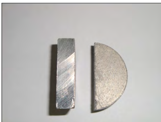
Figura 5. Secções transversal e longitudinal dos discos dos compósitos óbitos por sinterização a vácuo.
