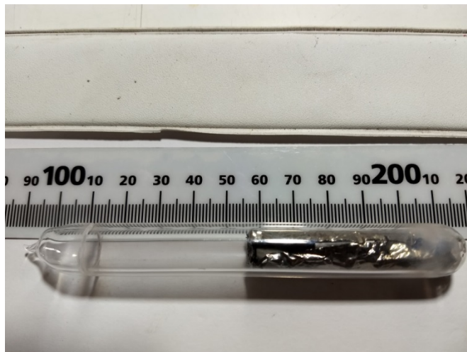
Figura 1. Mistura homogênea precursora do compósito compactada envolta em uma folha de tântalo e selada à vácuo em tubo de quartzo.
