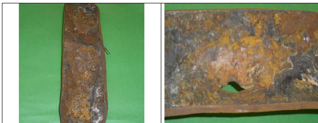
Figura 8 – Detalhe da parte interna da serpentina
