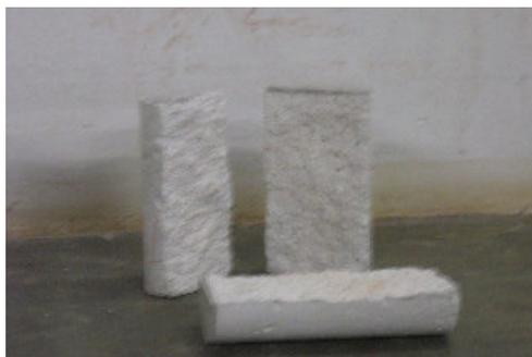
**Figura 8** – AC - argamassa com agregado de concreto.
