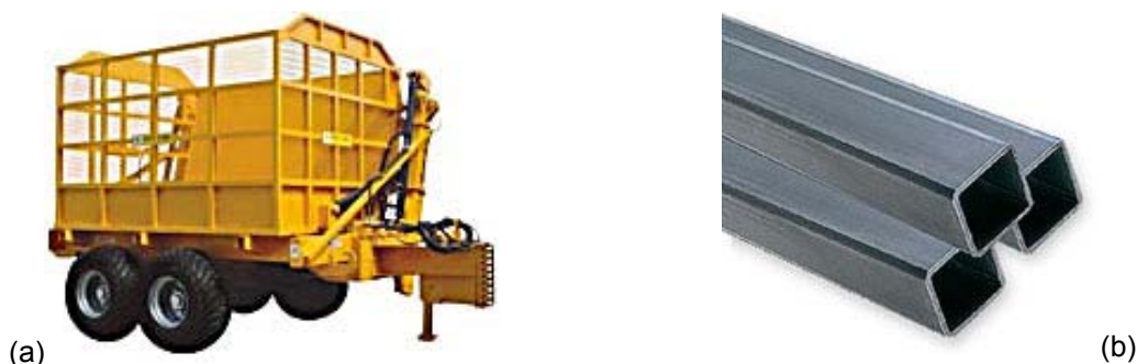
Figura 4 – (a) Carreta de transporte de cana-de-açúcar e (b) exemplos de tubos que compõem sua estrutura.
