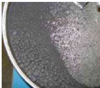
Figura 2. Fabricação das Pelotas no disco pelletizador.
