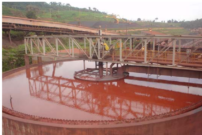
Figura 2. Espessador onde está aplicado o sistema especialista.
