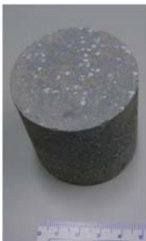
**Figura 3.** Imagem do compósito cimento/madeira/poliestireno expandido.
