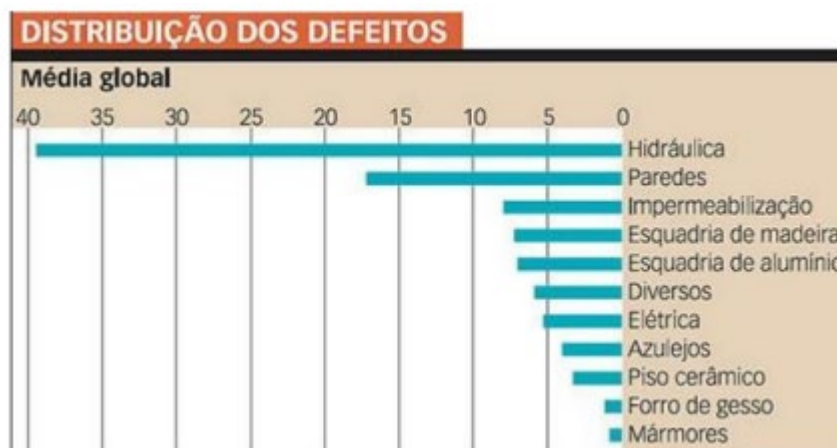
Figura 2. Média global de manifestações patológicas na construção civil [8].
