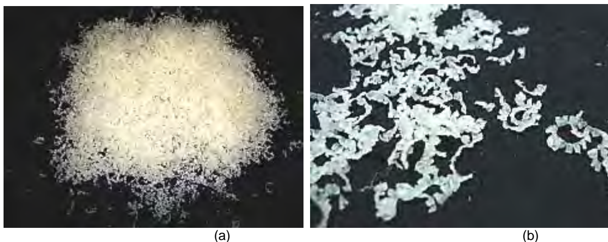
Figura 12. Ferramenta CCGT 120408-BAL, utilizando v_c = 600 m/min. (a) Volume total, (b) Ampliação.
