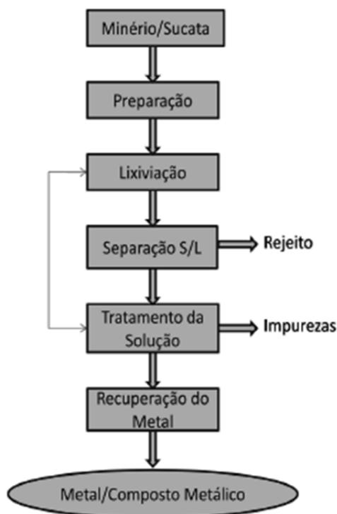
Figura 1. Etapas de um processo hidrometalúrgico.<sup>(2)</sup>
