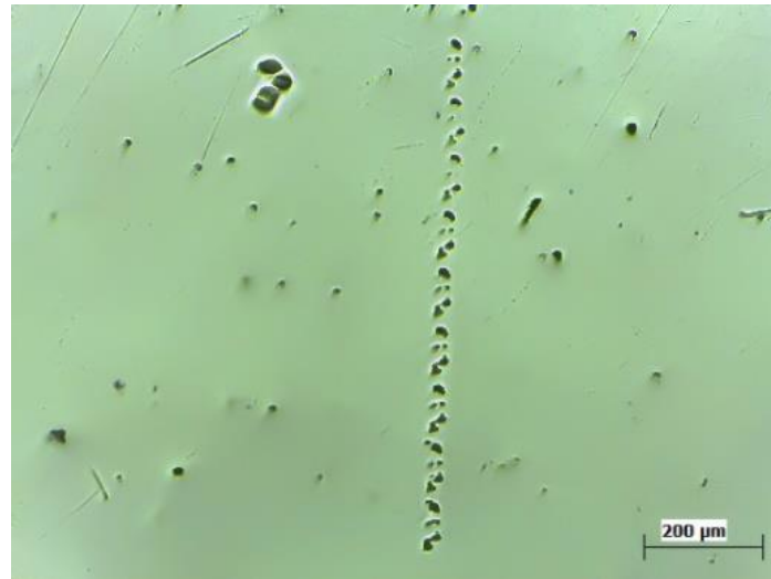
Figura 8. Fotografia da amostra 4 na secção SD evidenciando uma inclusão do tipo alumina.
