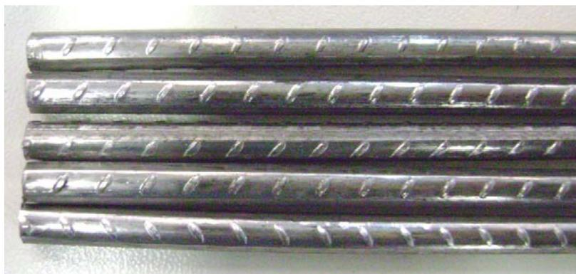
**Figura 3.** Amostras do arame trefilado CA-60 4,20 mm.
