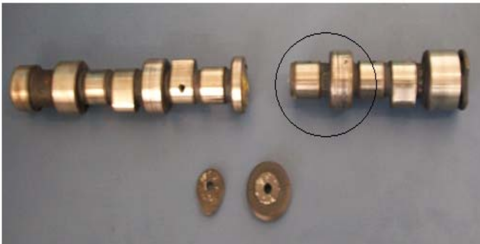
Figura 4 – Eixo comando de válvulas fraturado e as superfícies complementares geradas na fratura do equipamento. A região em destaque mostra as marcas de provável falta de lubrificação durante operação da peça.
