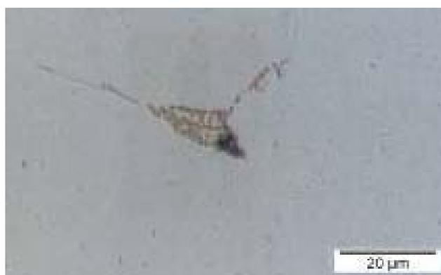
**Figura 9.** Microestrutura bruta de forjamento de um AISI H13, apresentando uma formação eutética. Aumento: 1.000 X.
