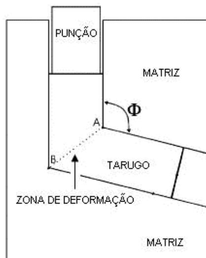
Figura 1: Desenho esquemático do método ECAP.<sup>(4)</sup>
