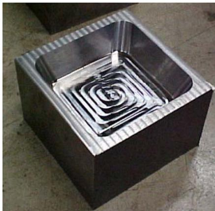
**Figura 1.** Abertura de cavidade padrão em fresamento.
