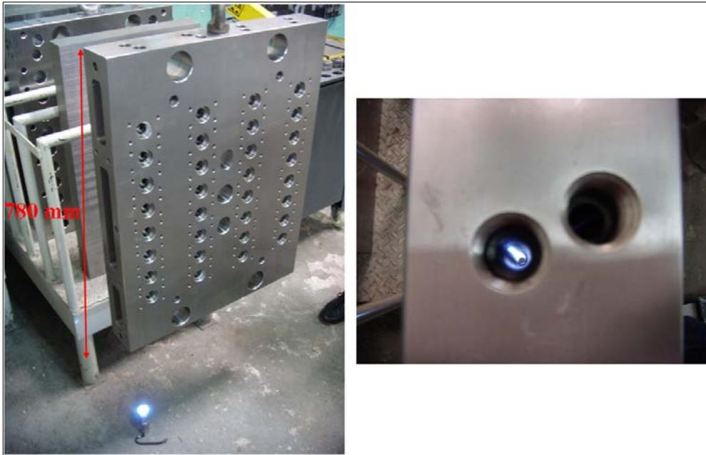
**Figura 11.** Placa de refrigeração produzida em aço Vimcor.
