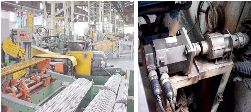
Figuras 6a e 6b. Retífica de Acabamento Malcus e Servomotor Utilizado
