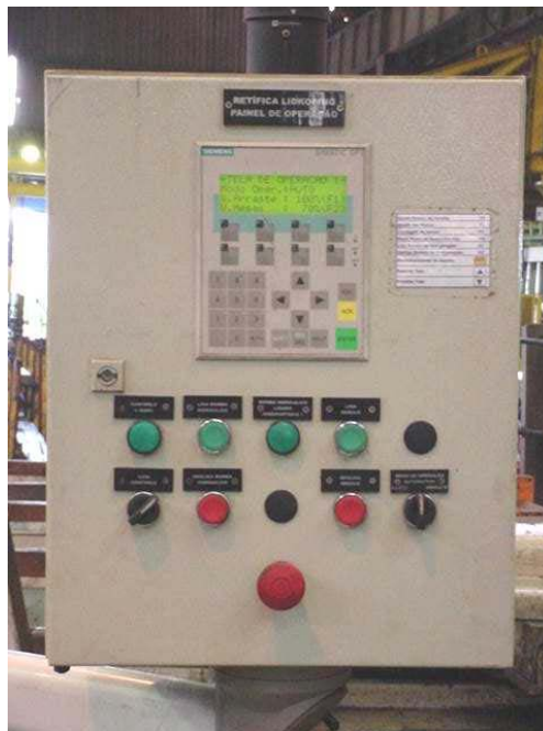
Figuras 3a e 3b. Painel Elétrico e Pulpito de Uma Retífica Lidköping.
