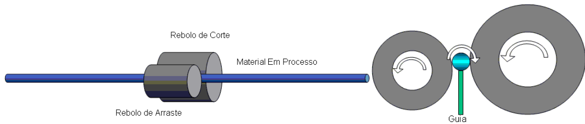
Figuras 1a e 1b. Efeito do Rebolo de Corte Sobre o Rebolo de Arraste.
