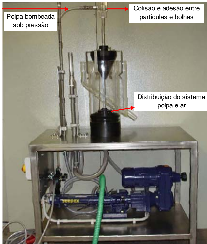
Figura 2. Célula pneumática usada nos testes piloto.
