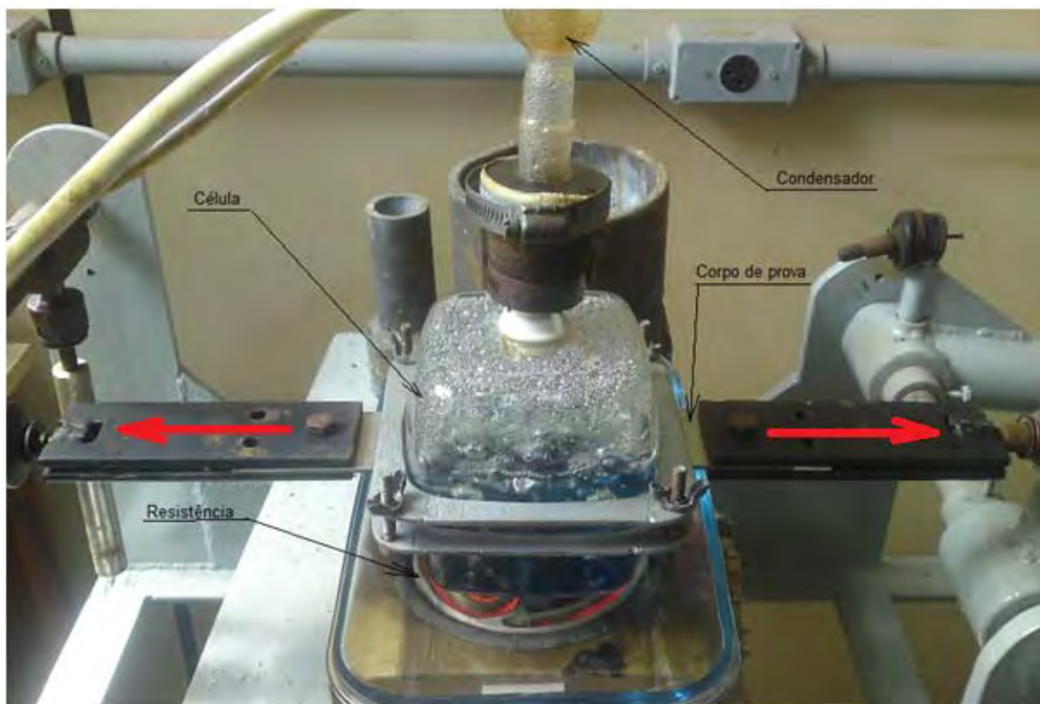
Figura 3 – Sistema para ensaios de corrosão sob tensão com carga constante em meio aquoso a quente; as setas indicam as hastes para aplicação de cargas trativas.
