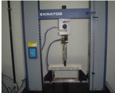
Figura 4 - Corpo de prova durante o ensaio de flexão
