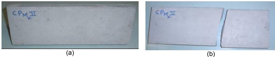
**Figura 6** - (a) Corpo de prova matriz antes do ensaio; (b) Corpo de prova matriz depois do ensaio.
