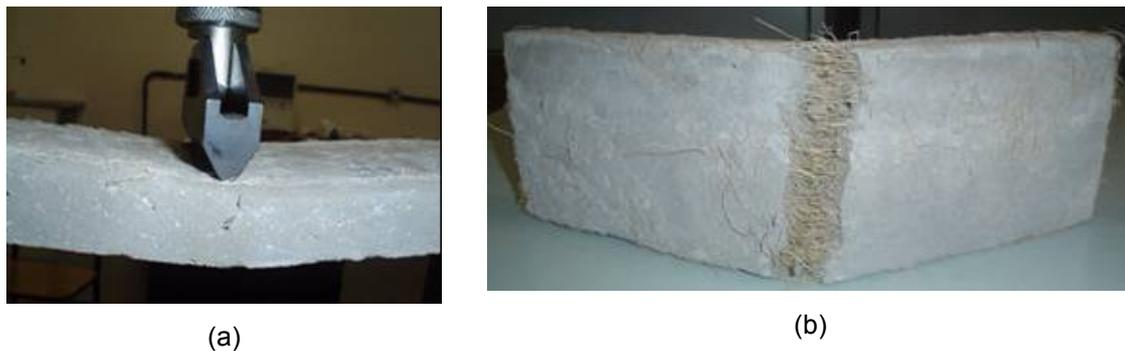
**Figura 7** - (a) Comportamento do material durante o ensaio de flexão; (b) Detalhe da fissuras no corpo de prova
