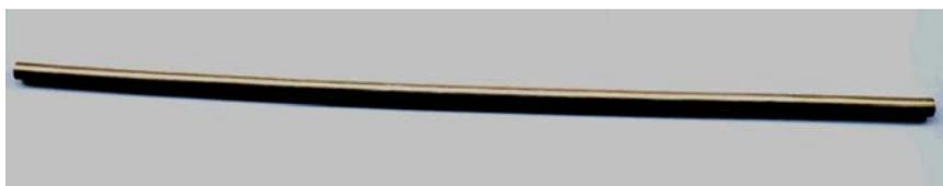
**Figura 1.** Lingote de uma liga monocristalina Cu-Al-Ni como recebida.
