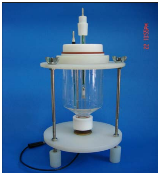
Figura 1. Célula Eletroquímica para os ensaios de corrosão.
