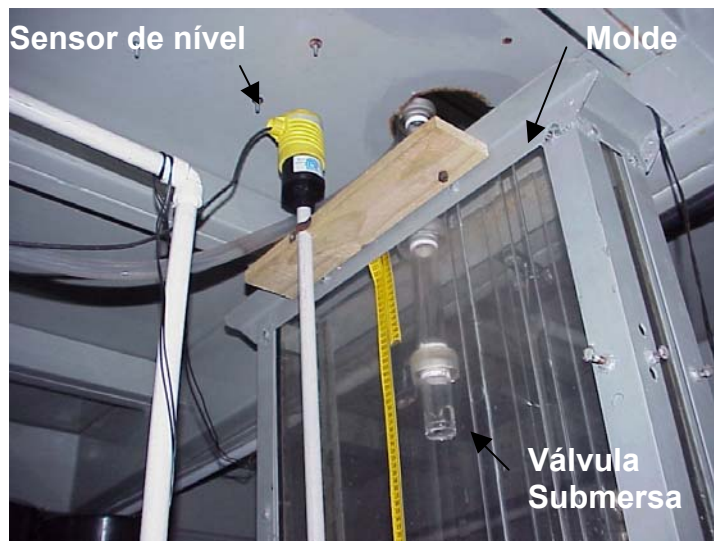
Figura 3 - Molde com sensor de nível e válvula submersa
