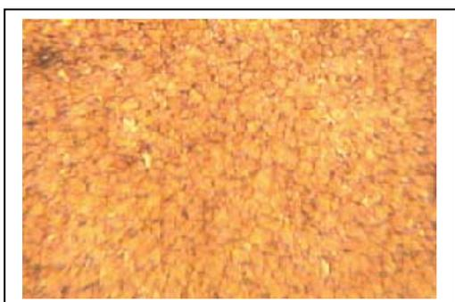
**Figura 4** : Microestrutura da amostra em aço M2 obtida com o ciclo de tratamento térmico C.
