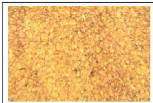
**Figura 7** : Microestrutura da amostra em aço M2 obtida com o ciclo de tratamento térmico F.
