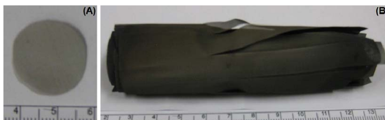
Figura 2 - Amostras da tela de aço inoxidável utilizada nos experimentos preliminares (A) e finais (B).
