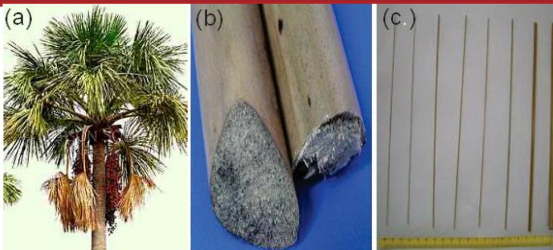
**Figura 1.** (a) Palmeira buriti, (b) pecíolos e (c) fibras extraídas.
