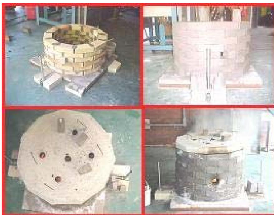
**Figura 1** – Forno experimental Alvenaria refratária em construção.
