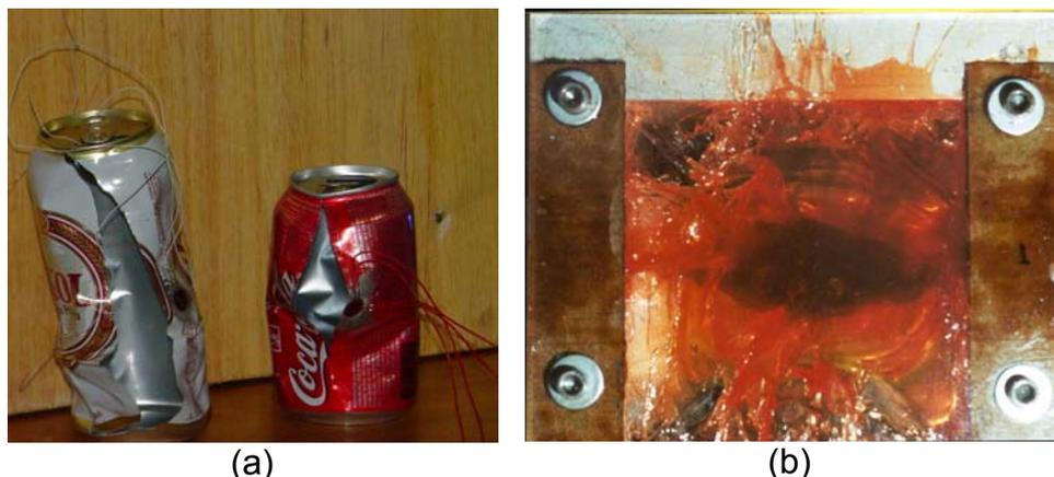
**Figura 5.** Falha catastrófica circunferencial, onde  $\sigma_1$  atua nas estruturas em casca cilíndrica (a). Imagem capturada no exato instante da ruptura catastrófica do vaso de pressão de parede fina em forma de “boca de peixe” (b).
