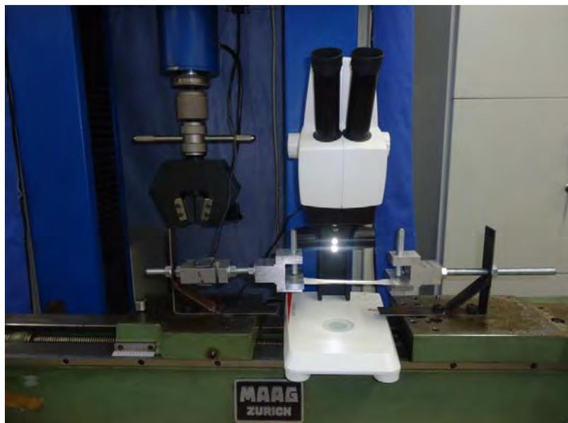
Figura 6. Estereoscópio acoplado a máquina de tração horizontal e à EMIC.
