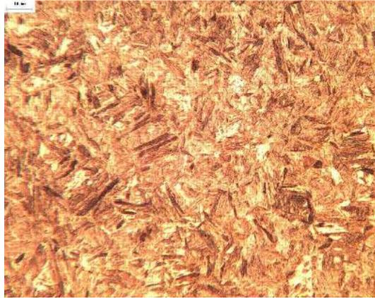
Figura 5- Aço AISI 41B30H Temperado com Ataque de Nital a 3% e Aumento de 500x.
