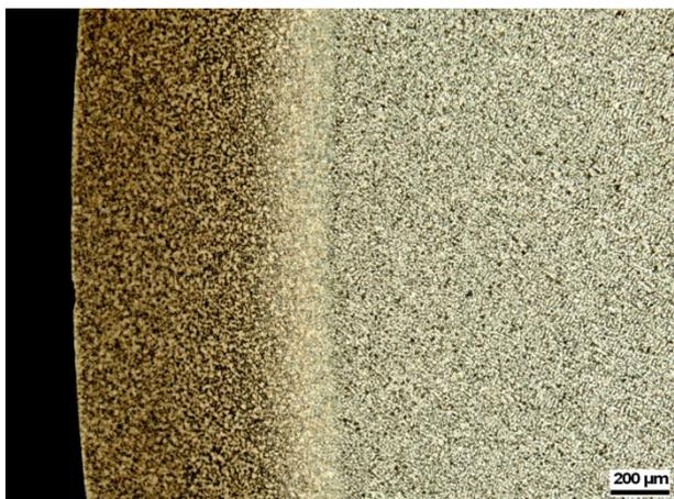
**Figura 2 – Macrografia da amostra temperada por indução 0,63 mm, ataque Nital 2%.**
