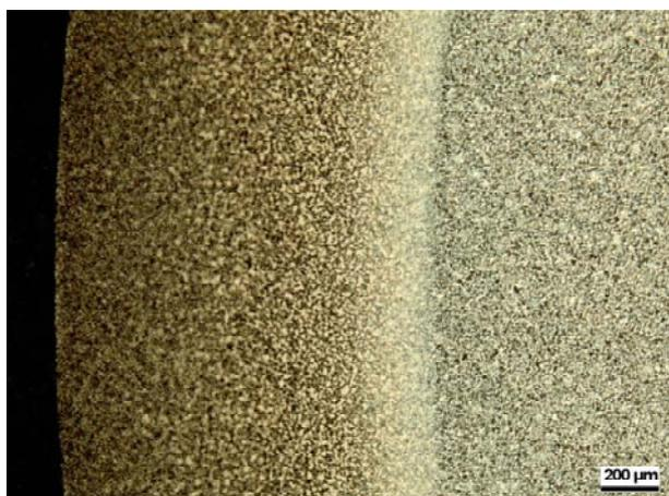
**Figura 4 - Macrografia da amostra temperada por indução 1,21 mm, ataque Nital 2%.**
