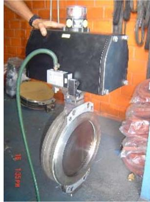
**Figura 8** - Válvulas automáticas de fechamento na saída do silo de finos.
