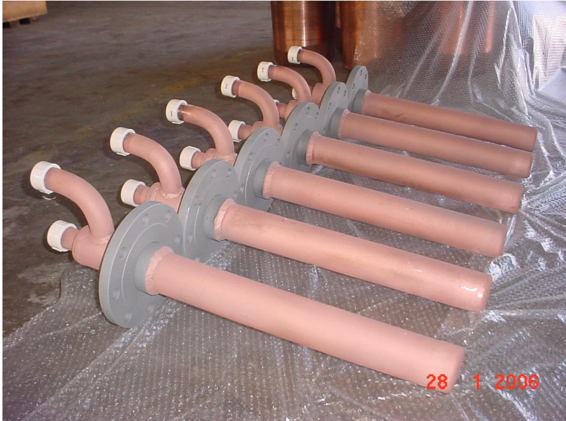
Figura 5. Cigar cooler instalados em 2010 no nível S-1.
