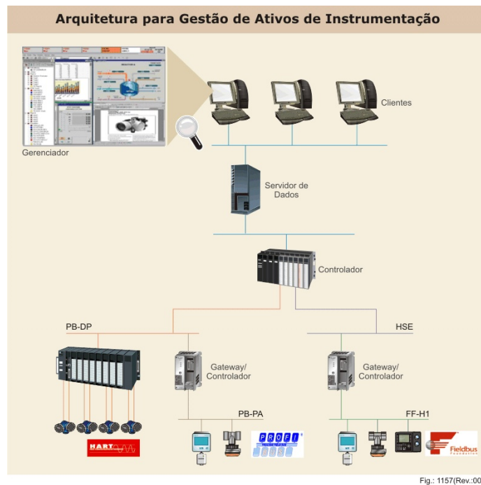
Figura 6. Configuração típica para gerenciamento de ativos de instrumentação
