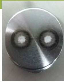
Figura 3. Amostra de imersão de aço inoxidável após análise por espectrometria.
