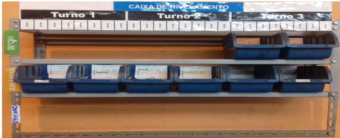
**Figura 6 – Imagem da Caixa de Nivelamento implantada no estudo de caso**
