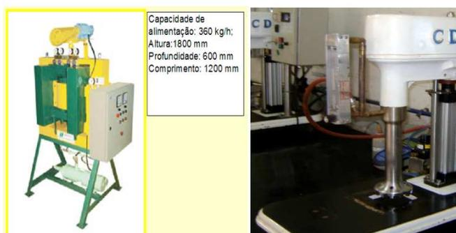
**Figura 3:** À direita o equipamento utilizado nos testes de separação magnética (Gauftec - Minimag G 340), e a esquerda o equipamento flotação em bancada (CDC - modelo 1000-EEP) utilizado nos testes de flotação.
