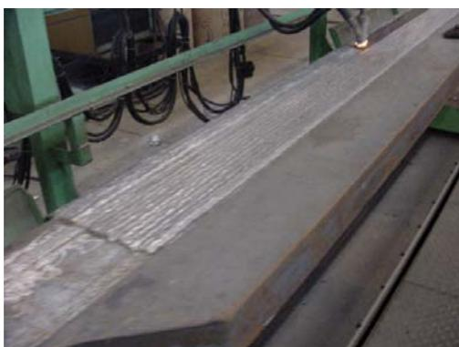
**Figura 3.** Soldagem do revestimento
