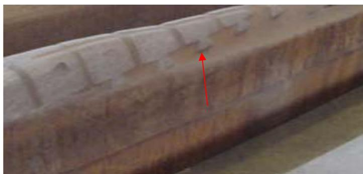
**Figura 7.** Barra desgastada , ancoragem
