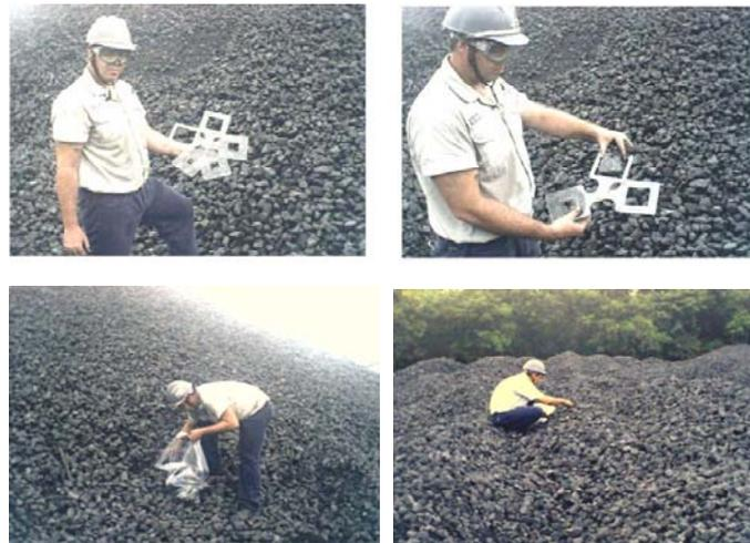
Figura 12 – Fotografias da coleta do coque nas pilhas.
