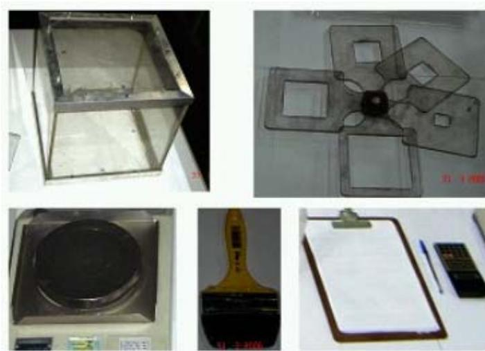
**Figura 8** – Componentes para a determinação do D.I. na pilha de coque.
