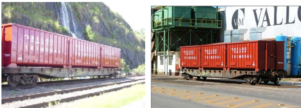
Figura 5. Caçambas interligadas sobre vagão
