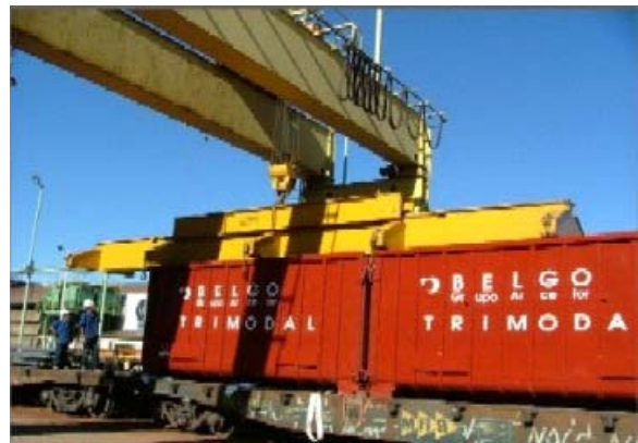
Figura 14. Desembarque da caçamba com produtos no terminal de transbordo
