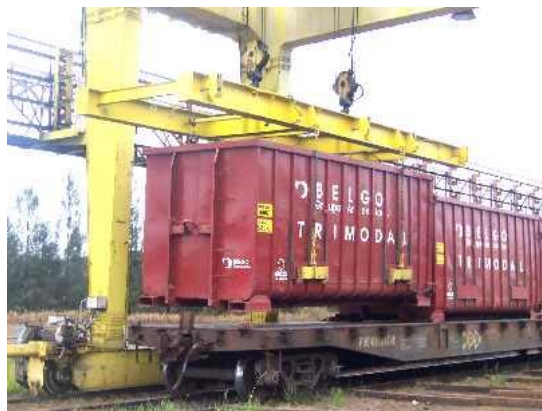
Figura 11. Desembarque das caçambas com sucata no terminal da Usina
