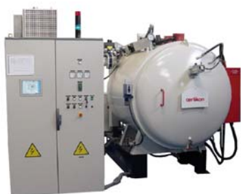
Forno de nitretação à baixa pressão.
