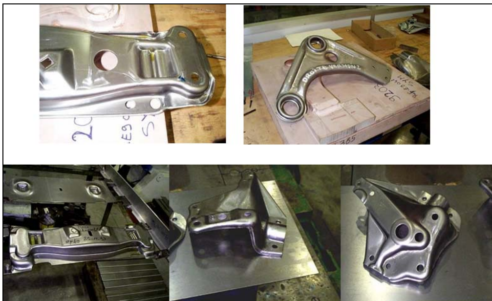
Figura 12 – Imagens mostram as chapas conformadas.
