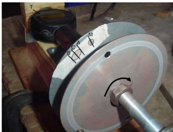
Figura 9. Protótipo do dispositivo utilizado para mensurar a velocidade das partículas nos testes. Nota-se a primeira marcação ( M ), alinhada com o furo do primeiro disco, foi feita com o dispositivo em repouso. As marcas defasadas, entre ( A ) e ( B ), indicam que as partículas não possuem a mesma velocidade, portanto, para o cálculo da velocidade adotou-se uma marca média ( C ). Um tacômetro ( T ) foi utilizado para medir a rotação do dispositivo.
