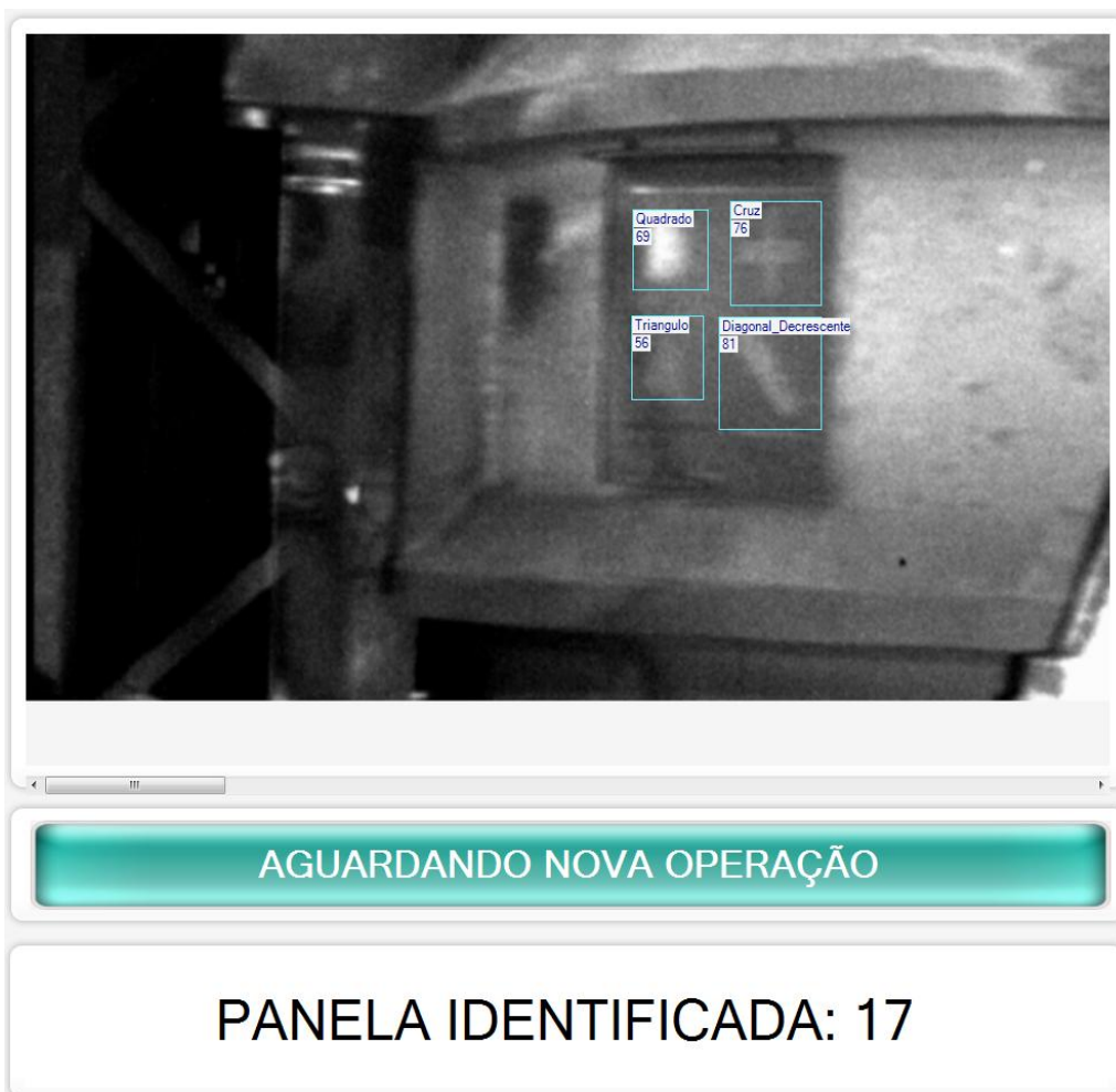
Figura 4. Identificação da panela mesmo com a placa encoberta por particulado, que seria de difícil reconhecimento pelo olho humano.
