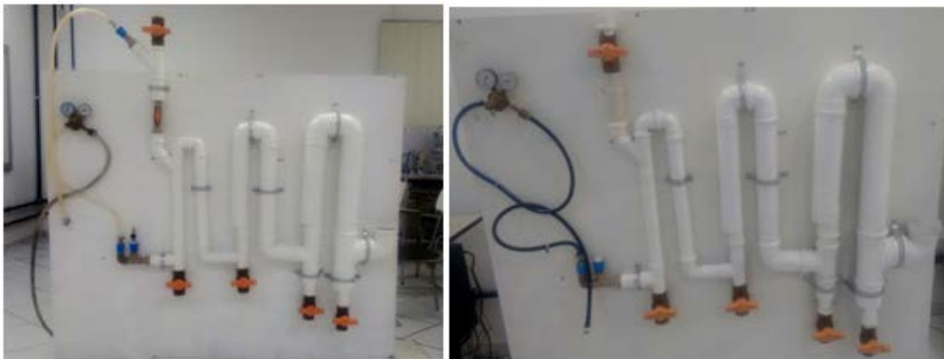
Figura 2. Elutriador antigo e novo, respectivamente.
