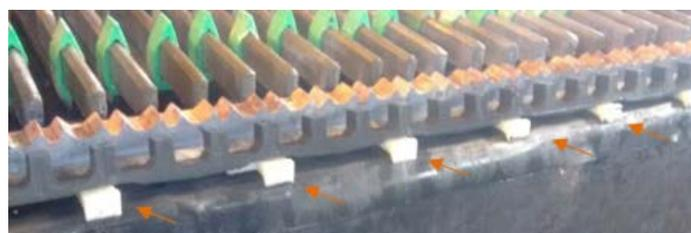
**Figura 14.** Suportes anteriores individualizados de fácil remoção e encaixe parcial.
