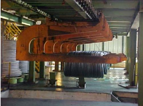
**Fig. 16 – Transportadores horizontais**
