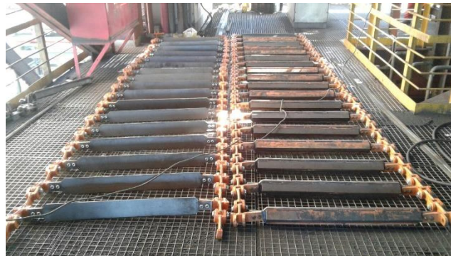
Figura 4 - A imagem apresenta a montagem da corrente utilizando elos novos e barras recuperadas devido falta de sobressalentes, em virtude do pouco tempo por excesso de quebra.
