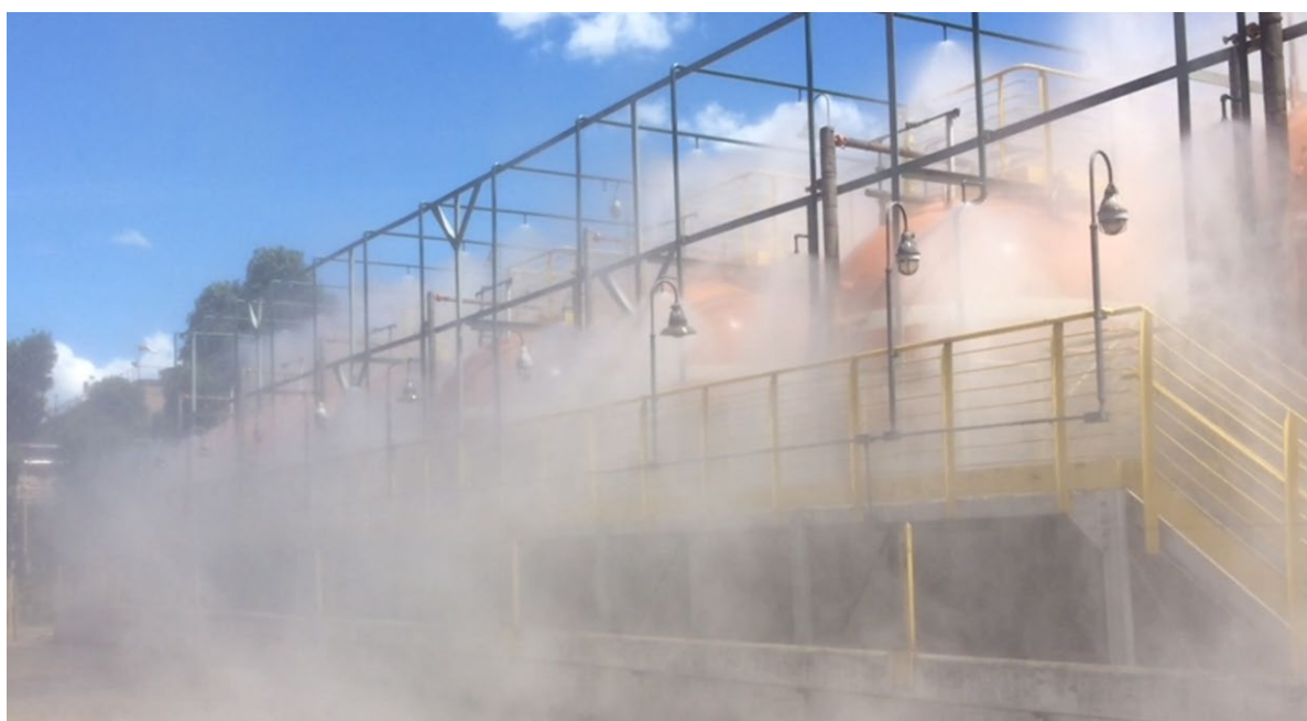
Figura 10 - Fotografia do teste de desempenho do sistema spray, após 5 s de funcionamento.
