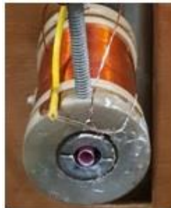
Figura 2. Bobina do equipamento de Susceptibilidade Magnética.
